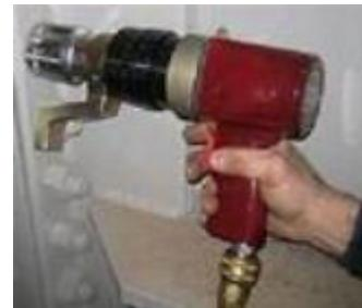
L'avvitatore è provvisto di un riduttore di velocità che diminuisce il numero di giri dell'utensile detto inserto. Alcuni riduttori hanno la possibilità di avere due o più velocità: le più lente per avvitare, le più veloci per forare. In alcuni modelli, il tasto funziona in modo analogico e la velocità del mandrino varia in modo proporzionale alla sua pressione.
